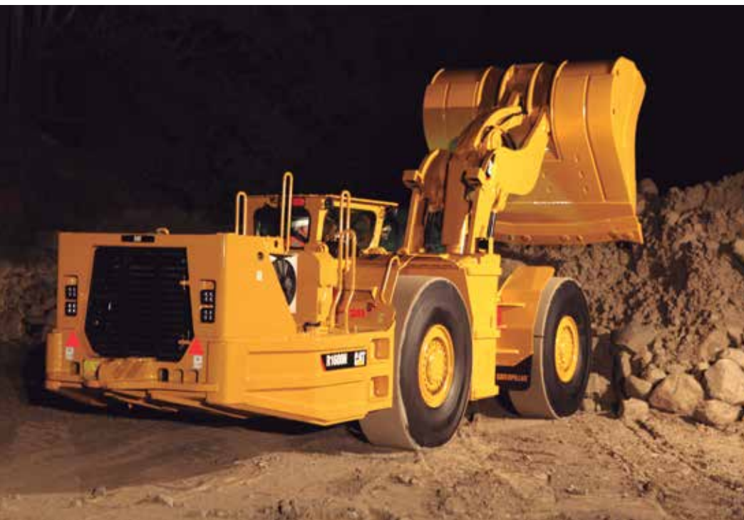
Los cargadores desde las 6.3yd 3 incorporan el sistema Ventilation Reduction (VR), que optimiza la mezcla aire-combustible y reduce los niveles de emisiones.
